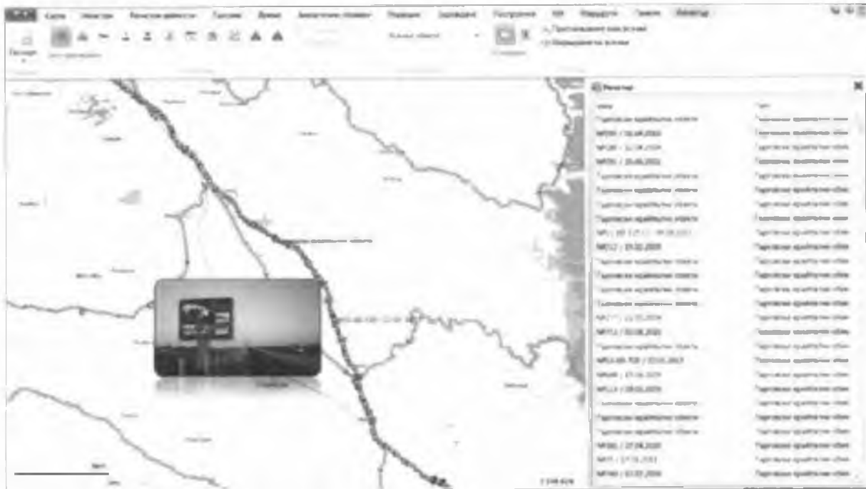
Екранна форма от ГИС на АПИ с поддържане на прикачени документи (снимки, документи, схеми, чертежи) и тяхното визуализиране върху карта
