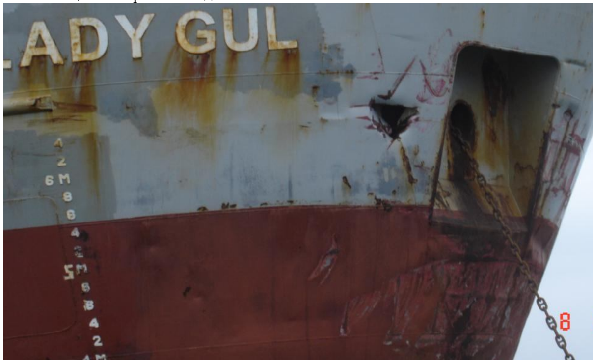
М/к „Lady Gul” – пробойна след сблъскването на 07.03.2013 г. Котвена стойка № 1 – Варна.
