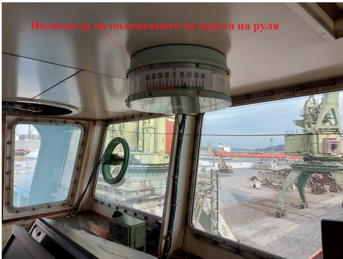
Фиг. 6 – Индикатор на положението на перото на руля, разположен на тавана на мостика.
