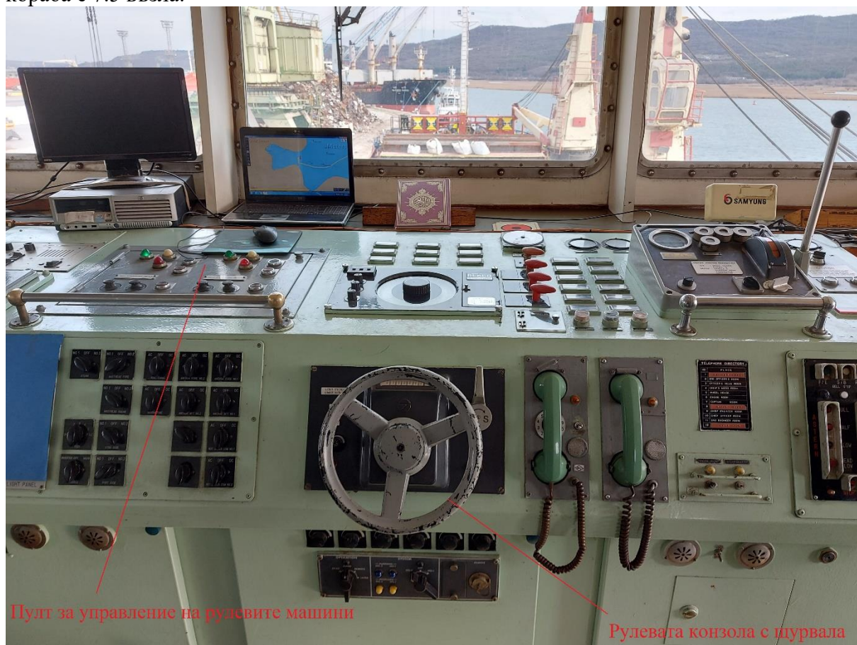
Фиг. 4 – Пулт на корабния мостик пред рулевия с рулевата конзола и пулта за управление на рулевите машини
