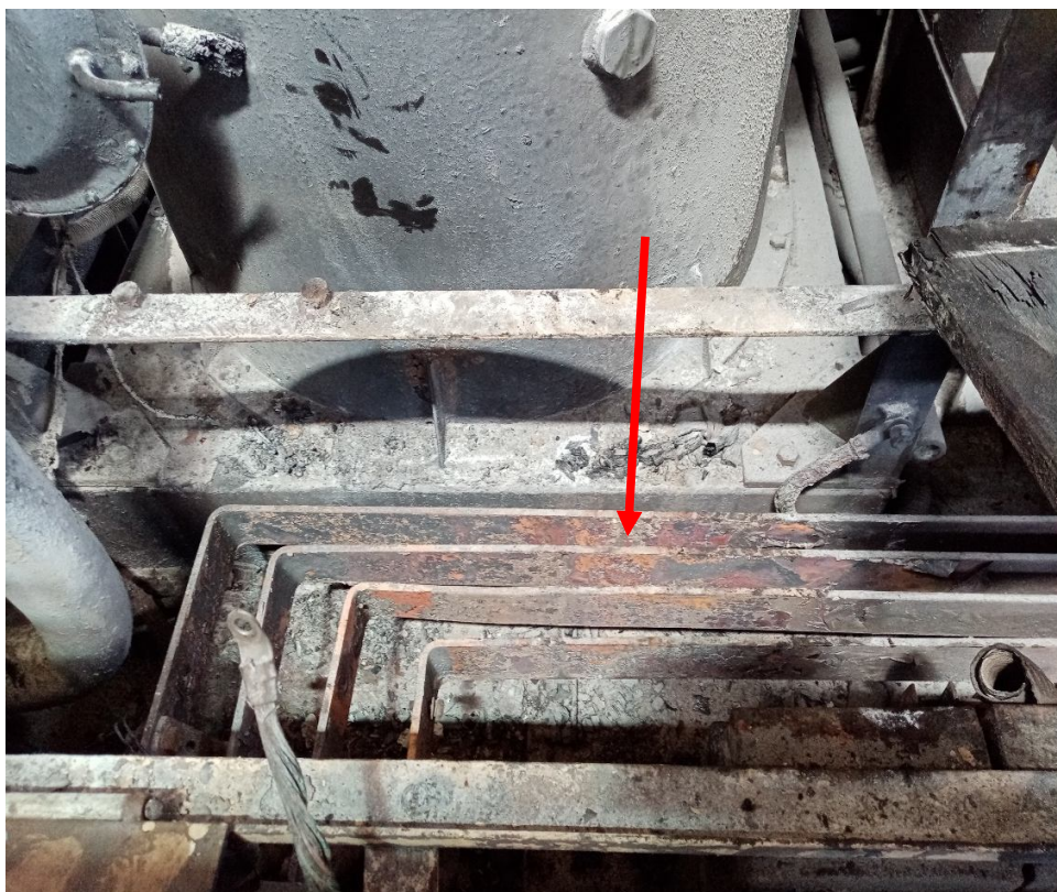
Фиг. 4.7. Опожарени шини на клемно табло на 3-ти тягов двигател.
