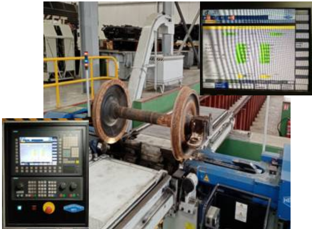
Фиг. 4.7. Снимка от измерване на колооста на колоосния струг с таблото за управление и дисплея с резултатите.
