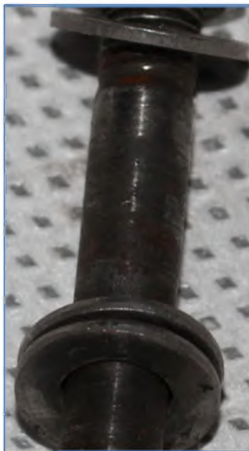
Фиг.2.11 Един от свързващи болтове на надлъжника на лявото полукрило към тялото.
