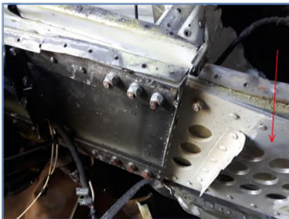
Фиг. 2.7 Свързващи болтове (3 горни и 3 долни) на надлъжника на дясното полукрило към тялото и един болт от частта към тялото (крилото е обърнато).
