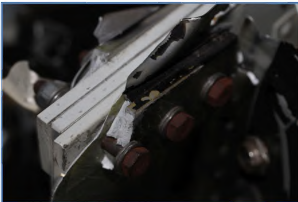
Фиг.2.10 Свързващи болтове (3 бр.) на долния пояс на надлъжника на лявото полукрило към тялото ( крилото е обърнато ).
