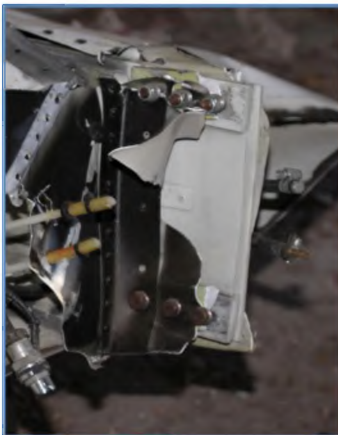
Фиг. 2.6 Свързващи болтове (3 горни и 3 долни) на надлъжника на лявото полукрило към тялото (крилото е обърнато).
