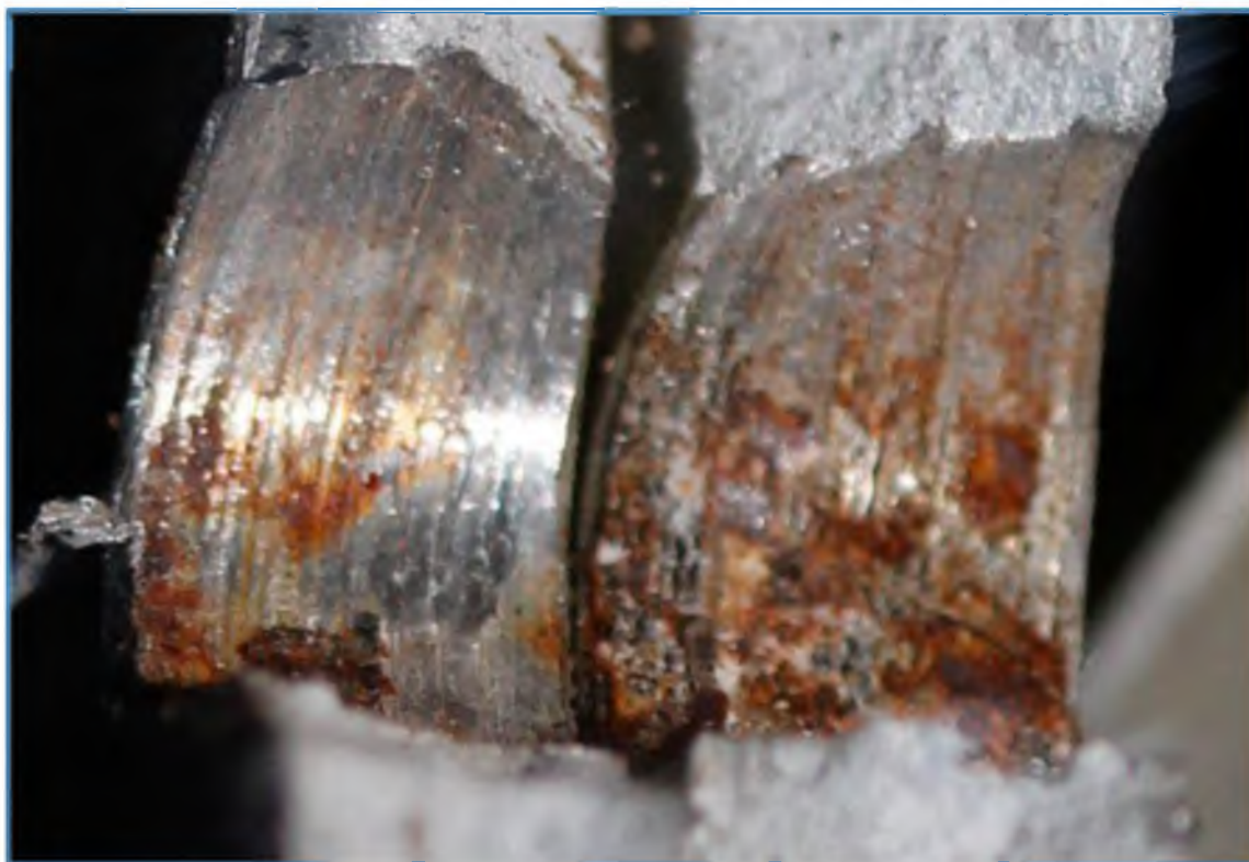
Фиг.2.12 Отвор в пояс на надлъжника за свързващ болтове на лявото полукрило към тялото (частта останала в тялото).
