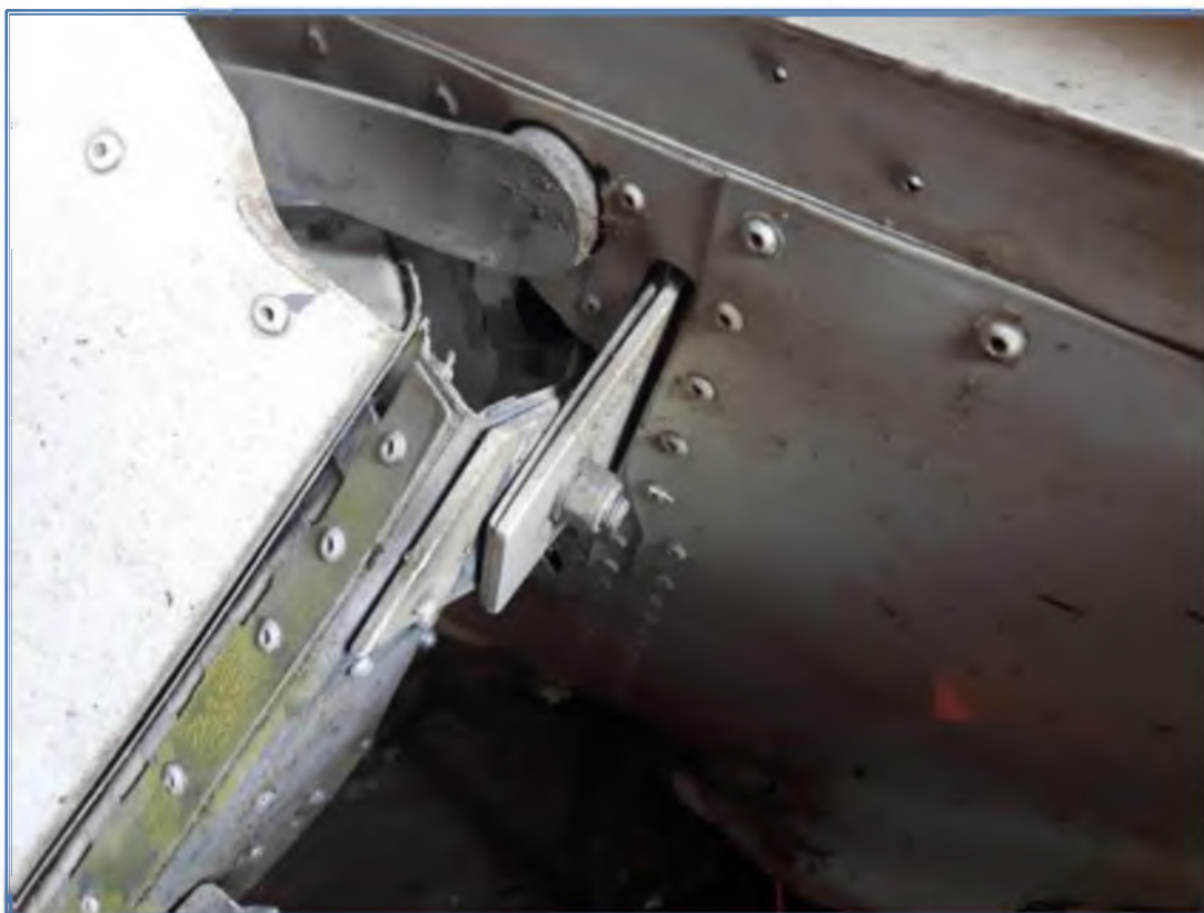
Фиг.2.8 Свързващ болт на стената на дясното полукрило към тялото ( крилото е обърнато ).
