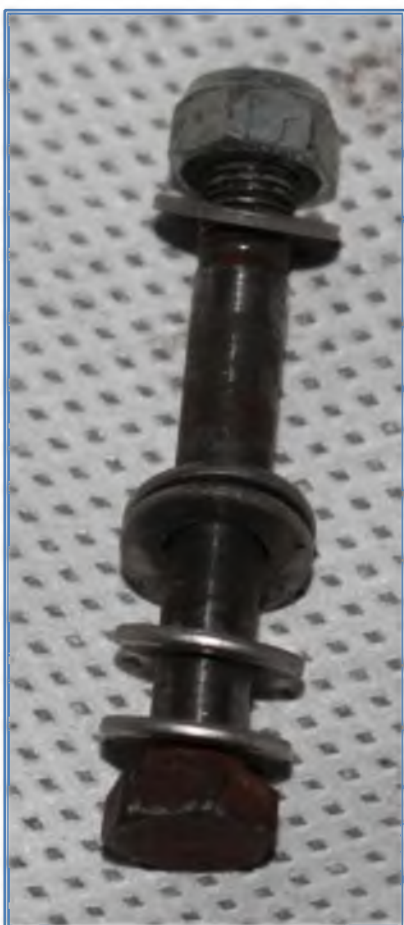
Фиг.2.11 Един от свързващи болтове на надлъжника на лявото полукрило към тялото.
