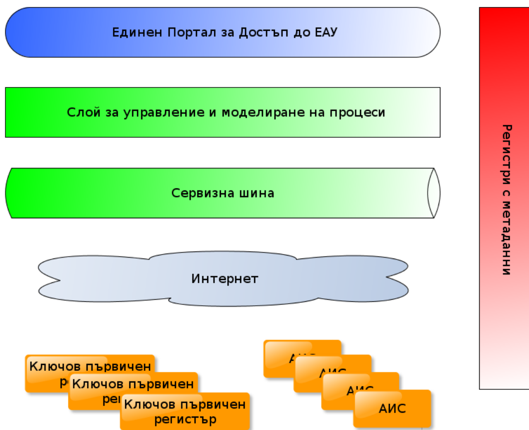
Фигура 2 Функционална архитектура при автоматизираното предоставяне на е-Услуги
