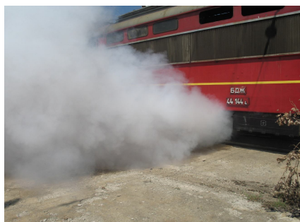
Проведени експерименти с различните видове генератори за аерозолно пожарогасене в ТПС
