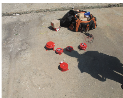
Проведени експерименти с различните видове генератори за аерозолно пожарогасене в ТПС
